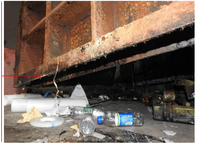
打包机后侧（机器直立状态下向东面）底座槽钢左下边缘刮擦痕迹
