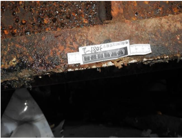
打包机后侧（机器直立状态下向东面）底座槽钢左下边缘刮擦痕迹
