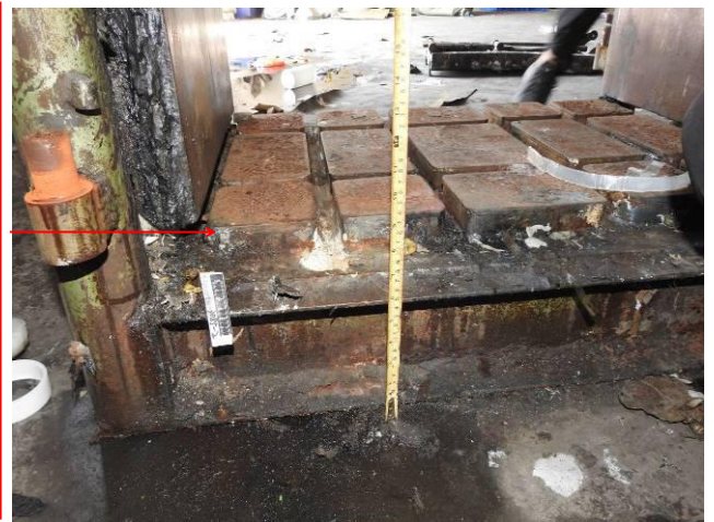
打包机后侧（机器直立状态下向东面）底座槽钢右上边缘刮擦痕迹
