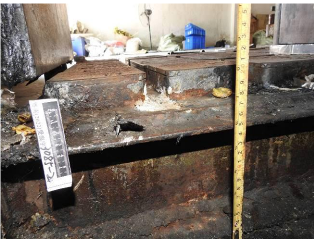
打包机后侧（机器直立状态下向东面）底座槽钢右上边缘刮擦痕迹
