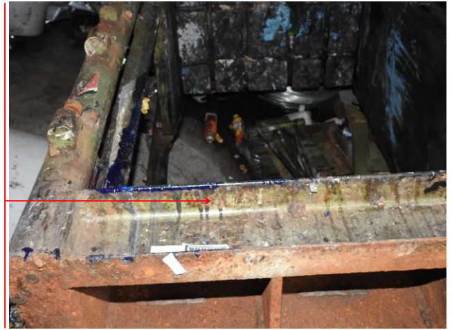
打包机前侧（机器直立状态下向西面）底座槽钢左上部内侧刮划痕迹
