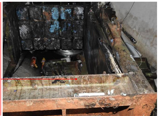
打包机前侧（机器直立状态下向西面）底座槽钢右上部内侧刮划痕迹
