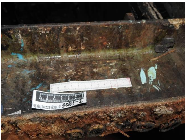
打包机前侧（机器直立状态下向西面）底座槽钢右上部内侧刮划痕迹
