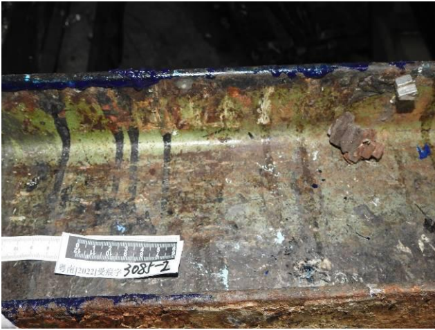
打包机前侧（机器直立状态下向西面）底座槽钢左上部内侧刮划痕迹
