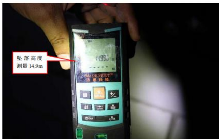
图 5 事故现场坠落高度
