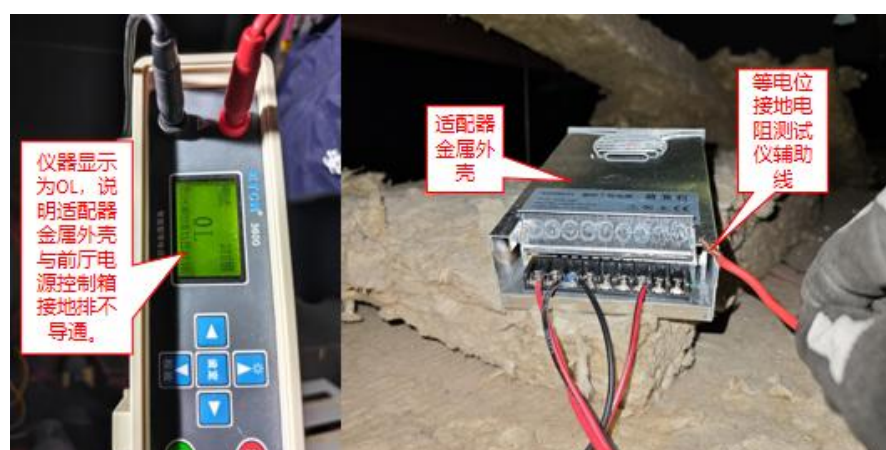
图 26 吊顶龙骨与前厅电源控制箱 PE 极等电位测试
