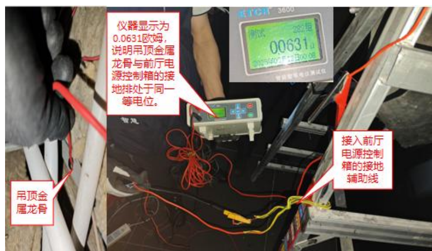
图 26 吊顶龙骨与前厅电源控制箱 PE 极等电位测试
