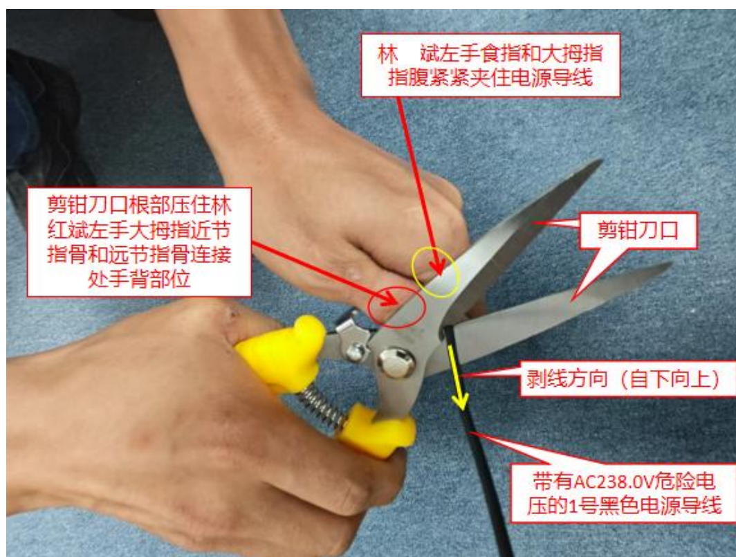
图 28 林某斌使用剪钳剥离电源导线模拟图
