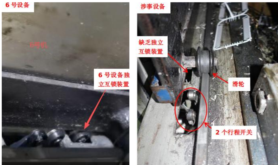
图6 涉事设备与6号设备联锁安全防护装置比较
